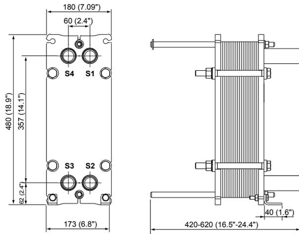
Die Anzahl der Spannbolzen kann je nach Druckauslegung unterschiedlich ausfallen.
