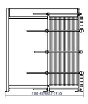
Die Anzahl der Spannbolzen kann je nach Druckauslegung unterschiedlich ausfallen.
