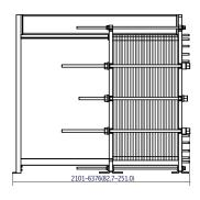
Die Anzahl der Spannbolzen kann je nach Druckauslegung unterschiedlich ausfallen.
